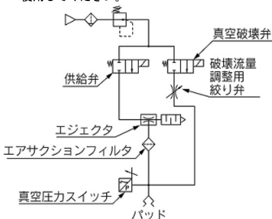
真空破壊側にもフィルタが必要な場合は真空吸着用とは別にフィルタを用意してください。
