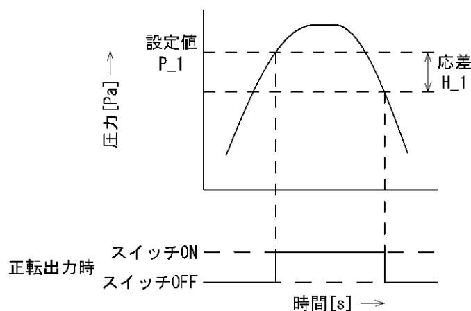
〈操作方法〉 ※：設定中も出力動作します。
