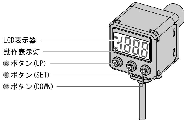
動作表示灯(橙) : スイッチの動作状況を表示します。
