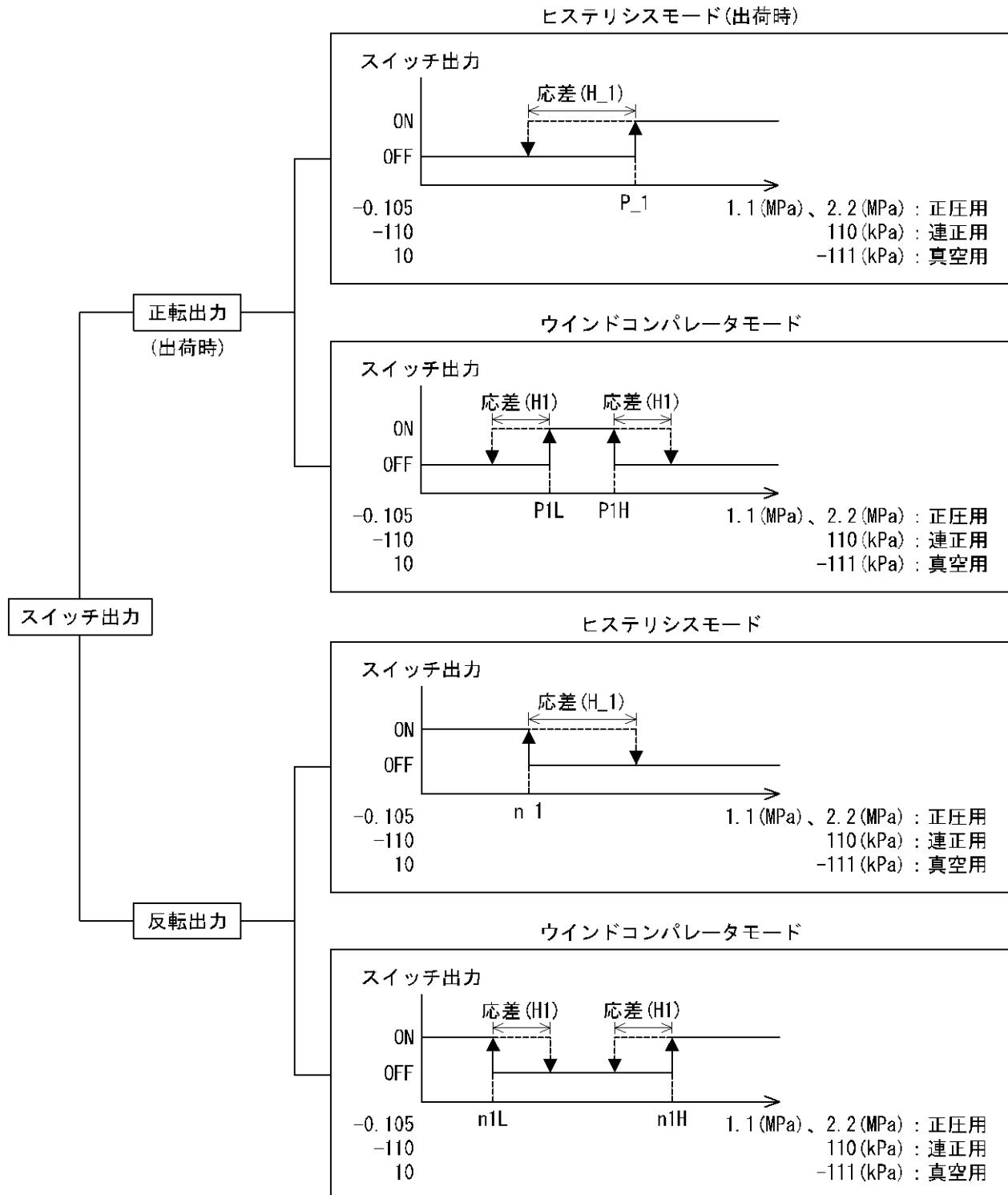
出力反転の選択により、スイッチ出力の切換わる点が設定圧力範囲外になる場合には応差が自動的に補正されます。
