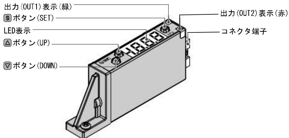
出力(OUT1)表示(緑)：スイッチ出力OUT1がON時に点灯します。
