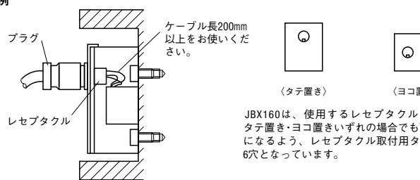
中継ボックスを金型へ取付けるには、2本のM8ボルトをボックス本体の背面へ通し固定してください。なお、この商品にはセンサからのケーブルを引きこも穴の加工はされておりません。
