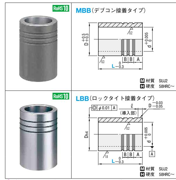
①ブッシュを冷やしばめしないでください。サブゼロ処理と同様に残留オーステナイトがマルテンサイトに変態して膨張し、ブッシュの内、外径ともに大きくなり、使用できなくなります。
