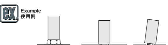
※ナット、バーリングネジが面に対して垂直になっているかを確認します。
