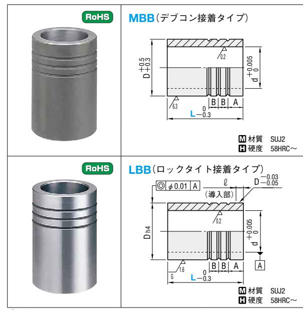
⑨ブッシュを冷やしばめしないでください。サブゼロ処理と同様に残留オーステナイトがマルテンサイトに変態して膨張し、ブッシュの内、外径ともに大きくなり、使用できなくなります。
