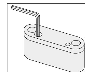
①パッキングプレートを固定している低頭ボルトをとりはずします。
