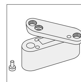
②スプリングピンを支点にパッキングプレートを回転させると、日付の下一桁の交換が簡単です。
