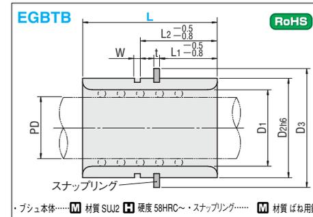
・プッシュ本体… 材質 SUJ2 硬度 58HRC～・スナップリング… 材質 ばね用鋼
