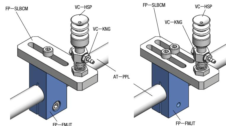
● 高さ調整が不要な場合、スライドブラケット(FP-SLBCM)を直接パイプジョイントに固定させ、コンパクトに仕上げることが可能です。
