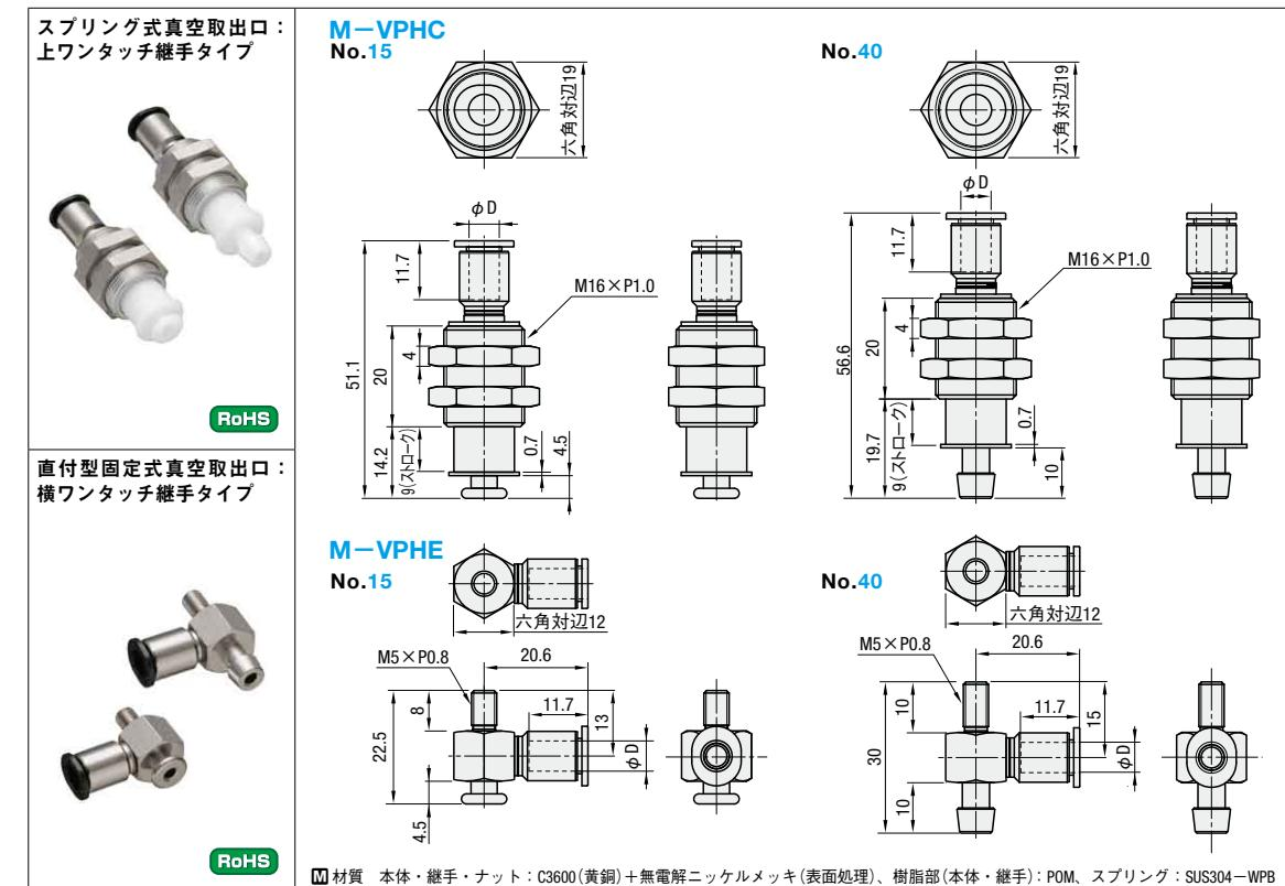
**M 材質** 本体・継手・ナット：C3600（黄銅）+無電解ニッケルメッキ（表面処理）、樹脂部（本体・継手）：POM、スプリング：SUS304—WPB
