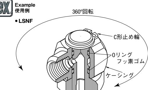
※ L型スイベルジョイントは金型取付時の方向変換用の商品です。
