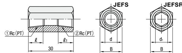
■材質 黄銅(C3604) ネジ部 JIS B0203 管用テーパネジ Rc(PT)
