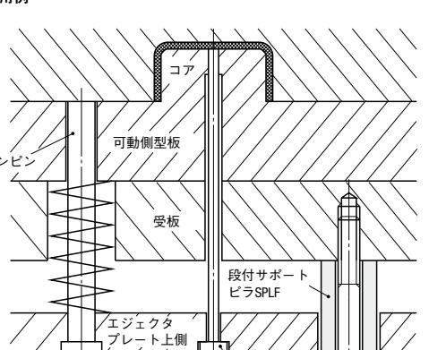
金型組み立て時、サポートピラの段部分がエジェクタプレート上側を押さえ、平行を保つので、エジェクタピンの挿入作業が容易になります。
