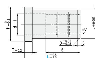
◎ 精級ガイドピン、精級サポートピンと精級ガイドブシューを組み合わせる場合、クリアランスが小さいので、型温80°C以下を目安としてご使用ください。(P.1002)
