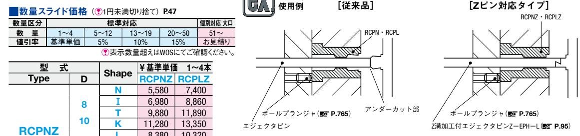
アンダーカット部の樹脂が離型する際、削れて粉が発生することがあるため、透明度の高い樹脂などをお使いの際には成形品への粉混入防止として有効です。また、従来品同様、六角レンチを用いてPL面からランナー溝の向きを変えることができます。位置決めにはボールプランジャーをご利用ください。
