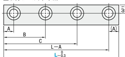
※ガイド溝高さ15mm(GR15□□)のみ適用ガイド溝高さ5mm・8mm(GR5□□・GR8□□)はC≤0.3となります。
