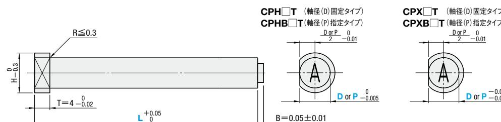
刻印加工の位置決めのために、標準 $0^\circ$ の位置にツバカット加工が施されます。
