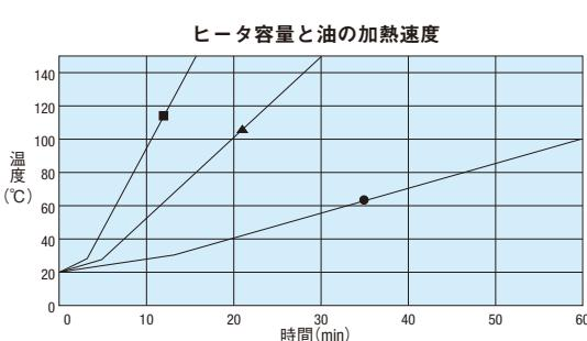
● 電力(電力密度)別昇温時間実測データ
