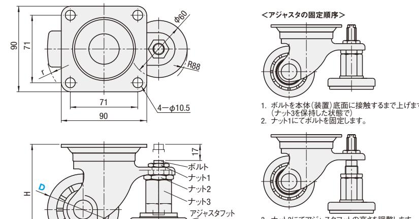
3. ナット3にてアジャスタフットの高さを調整します。
