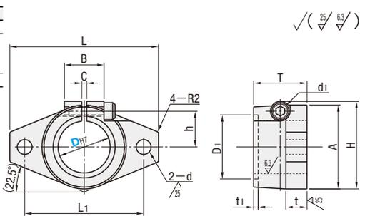
◎取付穴Dは許容差H7で加工後スリット加工をします。加工によってはH8程度に開く場合があります。
