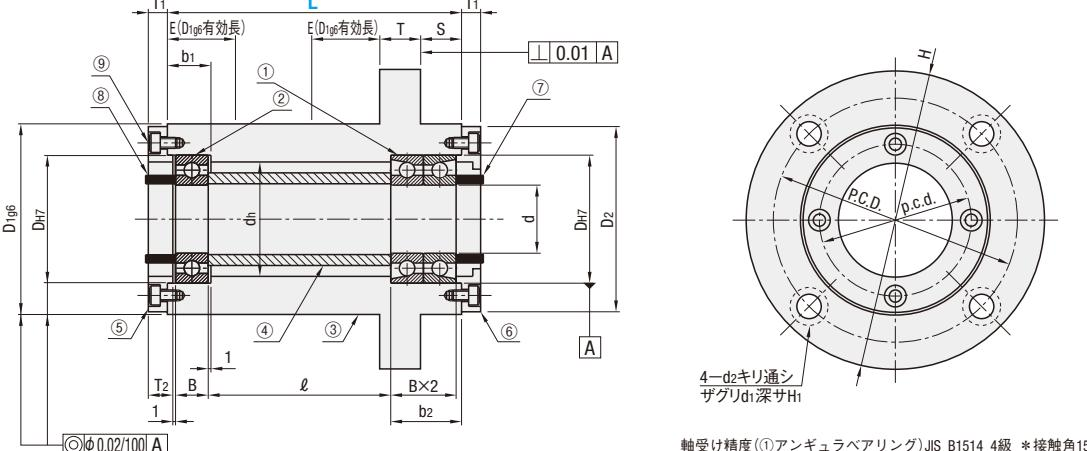
軸受け精度(①アンギュラベアリング)JIS B1514 4級 \*接觸角15°
