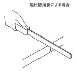
切断線を目安に、管軸に対して直角に切断します。
