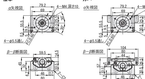
④有効ストロークはメカリミットまで片側2.5mm、計5mm隙間をもたらした値です。
