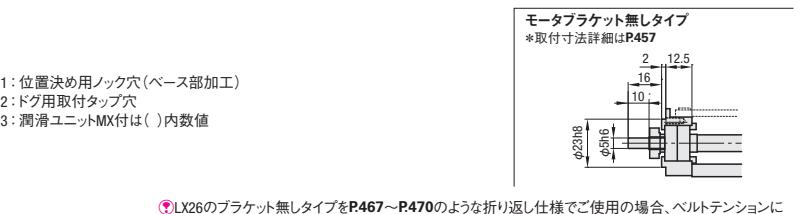
③有効ストロークはメカリミットまで片側2.5mm、計5mm隙間をもたせた値です。
