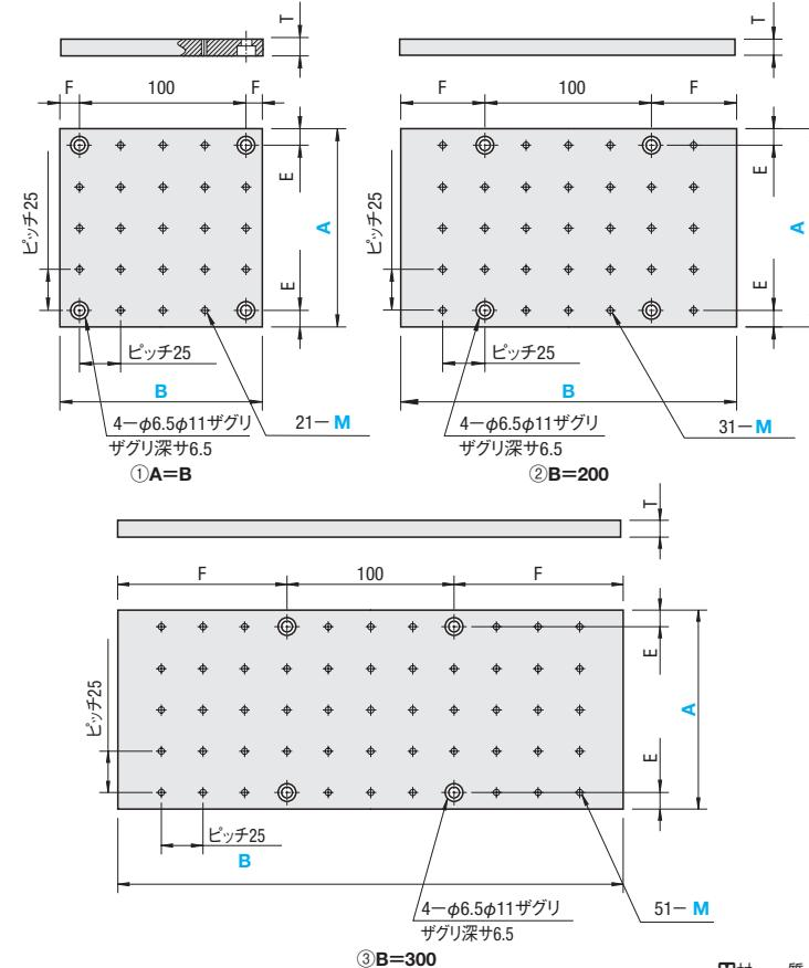
①取付穴はボード中心部に100mmピッチにてM6のボルト穴加工をしています。
