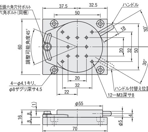
●上下面2枚のプレートはすり合わせ式のため、取付相手側の平面精度により摺動重さが変わることがあります。
