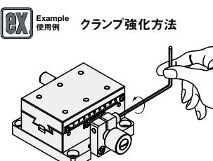
強化クランプのみの保持では、送り機構のガタが残りますので、クランプねじを併用してお使いください。
