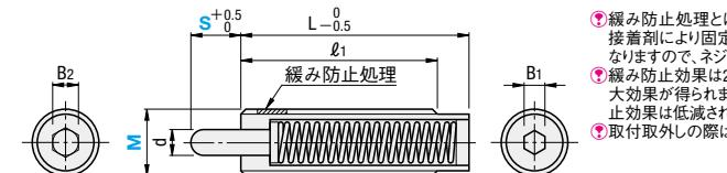
①緩み防止処理とはマイクロカプセルに封入された嫌気性接着剤により固定するものです。一度緩めたら効果がなくなりますので、ネジ用の嫌気性接着剤を使用してください。
