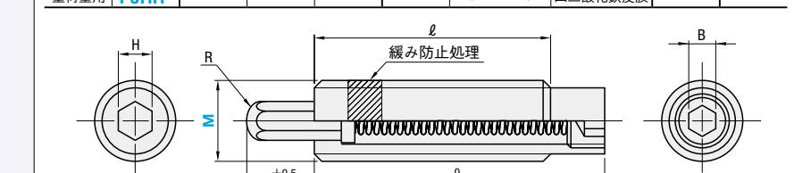
①緩み防止処理とはマイクロカプセルに封入された嫌気性接着剤により固定するものです。一度緩めたら効果がなくなりますので、ネジ用の嫌気性接着剤を使用してください。
