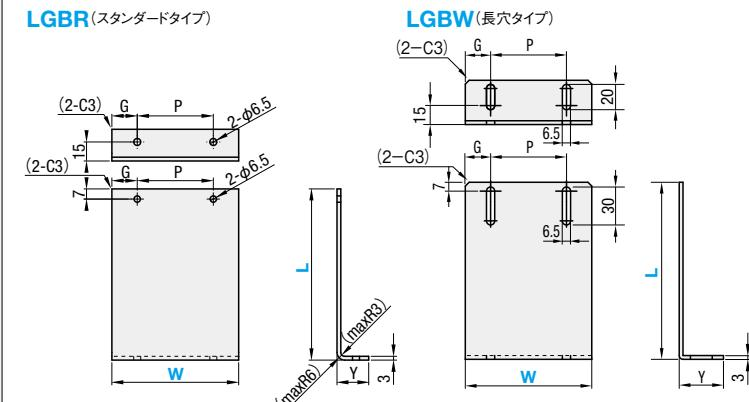
コンベヤ取付用ボルトは付属しません。コンベヤのナットサイズを確認いただき、ボルトをご用意ください。
