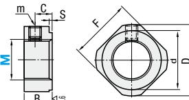
① 固定止めねじはセットビースを挿入の上、締め付けてください。
