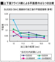
【試験方法】上記4材質(155×155×12mm)に1パス0.5mmずつ フライス加工を行い、平面度を測定(3次元測定器)。 上記より通常のSUS303/304に比べ、焼鈍 材品の方が加工後の平面度ばらつきが安定し ていることがわかります。
