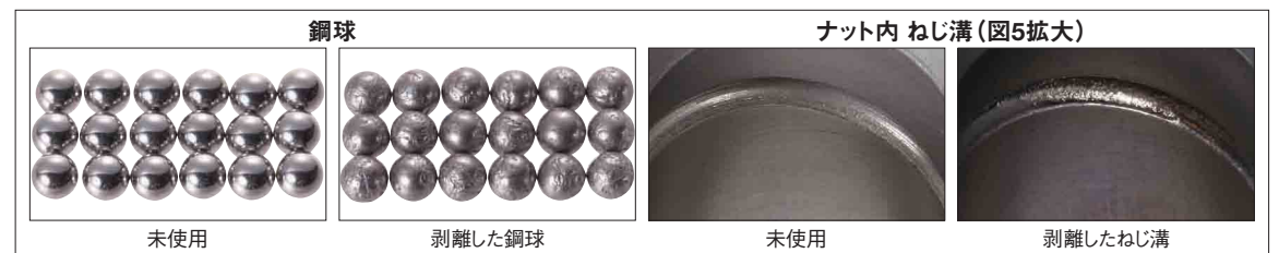
図6 剥離したボールねじ部品
