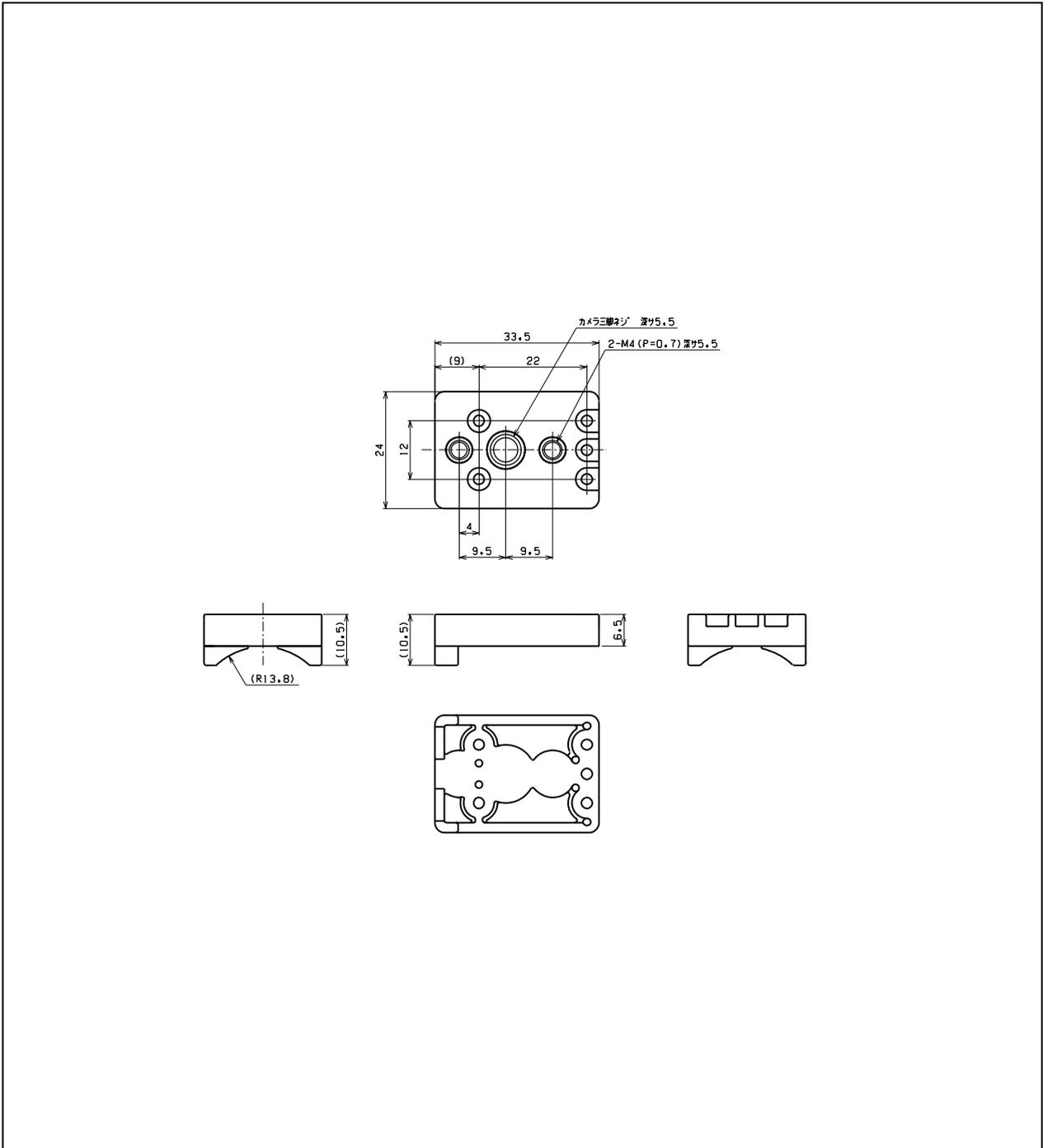
図 3 台座取付時外觀図面
