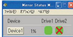
ホットスワップにてドライブ交換が可能です。自動的に再構築が始まり、上記プログレスが表示されます。
