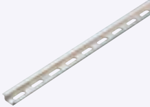
DIN15mm幅レール (取付穴: 4.2×12.2長穴)
