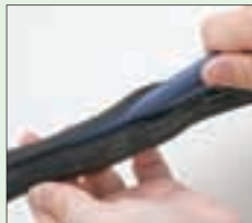
広げた編組チューブのスリット部分に電線を乗せるように押し入れます。
