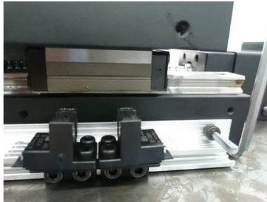
③ベース側面にセンサを取付ける 六角穴付ボルト：M4x8L（2箇所） 締付けトルク：4.6N・m
