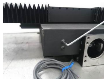
②エンドプレートのボルトを外す 六角穴付ボタンスクリュー（M4） 締付けトルク：1.8N・m
