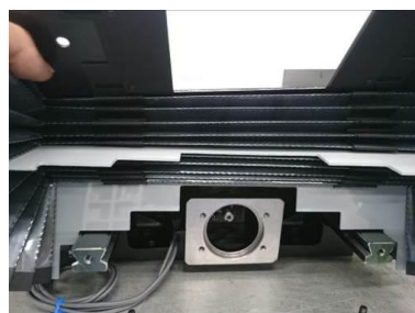
⑤2枚目の樹脂板も手前に引いて 外しジャバラをめくり上げる
