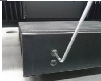
②エンドプレートのボルトを外す 六角穴付ボタンボルト (M4) 締付けトルク: 1.8\text{N} \cdot \text{m}
