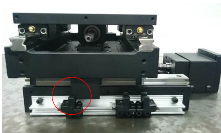
④センサドグ B とセンサが接触していないか、テーブルを手動で動かして確認する
