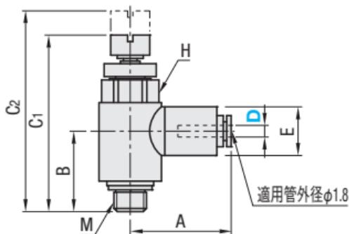
M材質 PBT(ポリブチレンテレフタレート)
