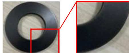
【変更後】仕上げ：ショットピーニングなし
