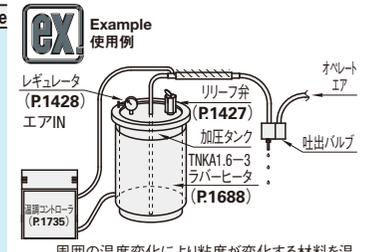
周囲の温度変化により粘度が変化する材料を温調し、粘度を一定に保ちながら加圧圧送します。
