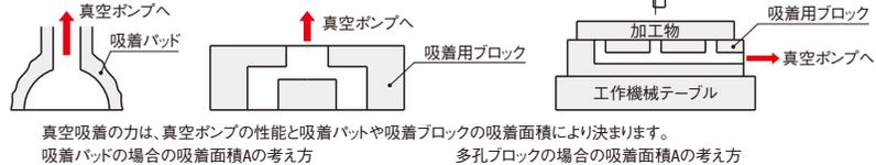
真空吸着の力は、真空ポンプの性能と吸着パッドや吸着ブロックの吸着面積により決まります。吸着パッドの場合の吸着面積Aの考え方 多孔ブロックの場合の吸着面積Aの考え方
