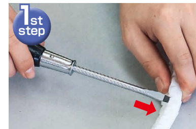
1st step リンクの裏側にマイナスドライバーを差し込む
