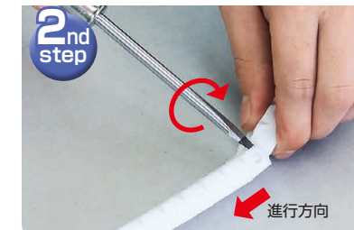
2nd step 進行方向に対し、マイナスドライバーを逆に回す
