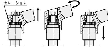
①レバーを引き上げると、セレーションの噛み合いが外れ、ロックが解除されます。
