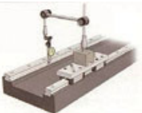
図5：従動側レールの固定方法
