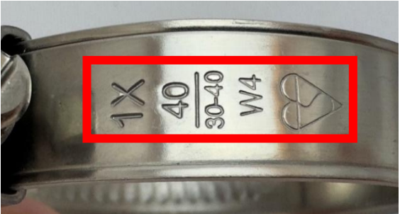
ホース外径締め付け範囲＋メーカー規格刻印
